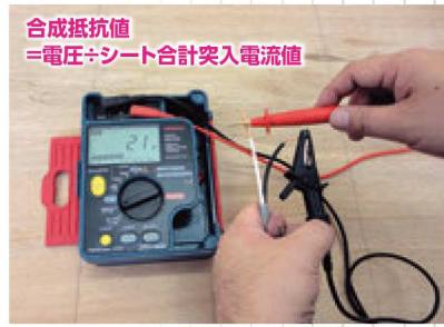
合成抵抗値検査を行います。本値はPTC特性により外気温度で左右されます。20°C環境で突入電流値に対して±20%程度が許容範囲内です。これより夏場はプラス冬場はマイナスの数値になりますので、外気温を考慮して測定してください。同時に絶縁抵抗(DC500V)検査も行います。
