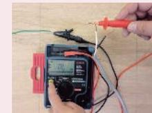
絶縁抵抗計（DC500V）で漏電チェックを行います。50MΩ以上で合格となりますが、下地合板が湿っている場合や雨天時には、50MΩ未満になる場合がありますので湿気を考慮の上測定してください。同時に合成抵抗値検査も行います。
