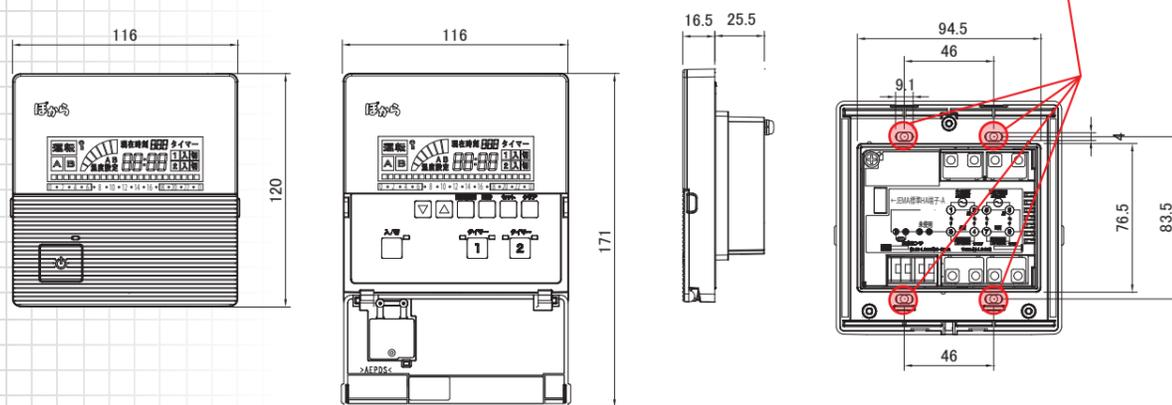
※コントローラボックスは付属しておりません。コントローラおよびリレーボックスはJISスイッチボックス2個用深型（小面積用は1個用深型）を現場調達し、ご使用願います。
