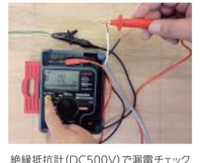
絶縁抵抗計 (DC500V) で漏電チェックを行います。50MΩ以上で合格としますが、下地合板が湿っている場合や雨天時には、50MΩ未満になる場合がありますので湿気を考慮の上測定してください。同時に合成抵抗値検査も行います。
