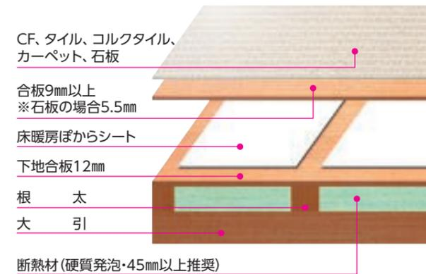
ぽからシート上に合板9mm以上(石板は5.5mm)をビス止めし、その上から耐熱用接着剤で仕上げ材を張ります。
