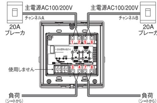
チャンネルA（①②③④）の負荷（③④）に15A以内を、チャンネルB（⑤⑥⑦⑧）の負荷（⑦⑧）に15A以内を接続します。（チャンネルA、Bは同時運転です。）
