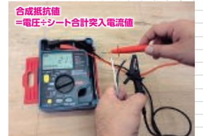
合成抵抗値検査を行います。本値はPTC特性により外気温度で左右されます。20℃環境で突入電流値に対して±20%程度が許容範囲内です。これより夏場はプラス冬場はマイナスの数値になりますので、外気温を考慮して測定してください。同時に絶縁抵抗 (DC500V) 検査も行います。
