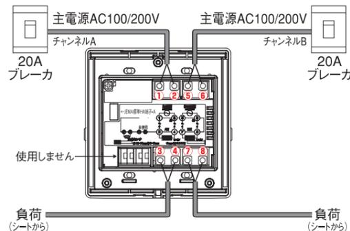
チャンネルA（①②③④）の負荷（③④）に15A以内を、チャンネルB（⑤⑥⑦⑧）の負荷（⑦⑧）に15A以内を接続します。（チャンネルA、Bは独立運転です。）
