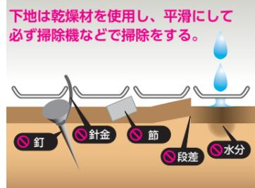
下地は乾燥材を使用し、平滑にして必ず掃除機などで掃除をする。
