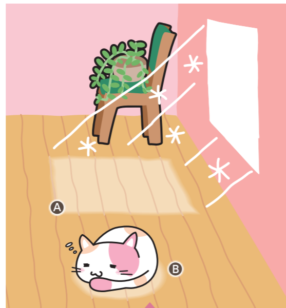
A・Bの場所では、ヒーター自体が電流を少なくし、温度の上昇を抑制します。A・B以外の場所では、通常どおり電流が流れています。
