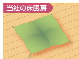
当社の床暖房 温度が上がった部分だけ発熱、電力消費を抑え、過昇温を防ぎます。
