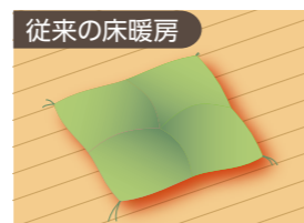
従来の床暖房 モノを置くと、その下だけに熱がこもり、異常昇温することがありました。
